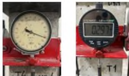
5,6 - механический и электронный измерители деформаций с ценой деления 0.001мм
