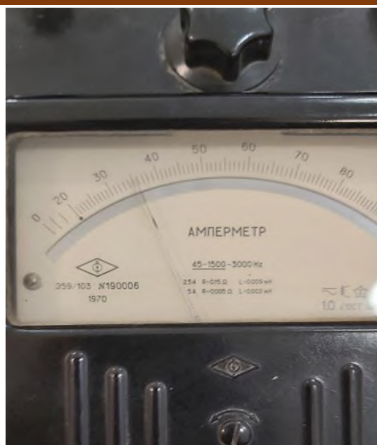
Рисунок 9 – Показания амперметра при коротком замыкании 5 витков
