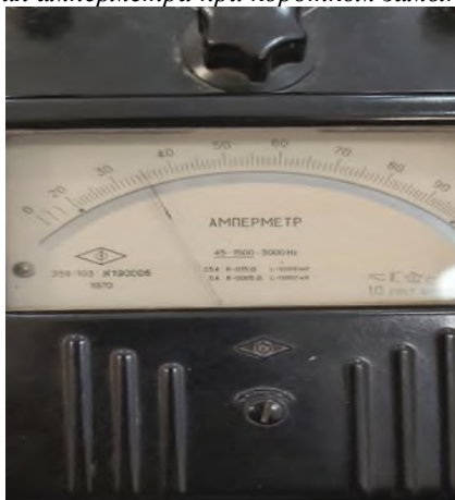
Рисунок 8 – Показания амперметра при коротком замыкании 3 витков
