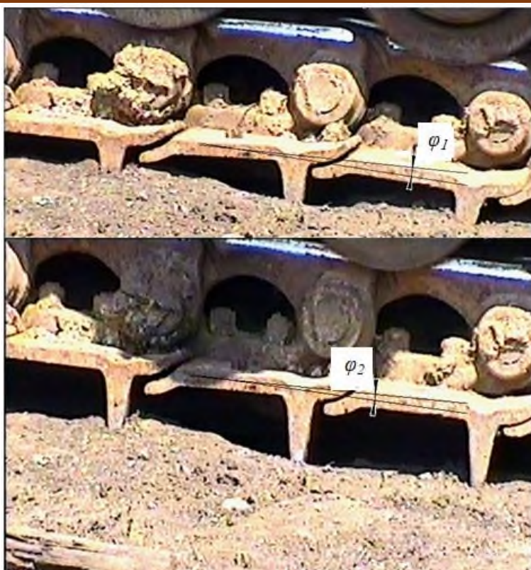
Рисунок 4 – Пример определения относительного угла поворота траков [5]
