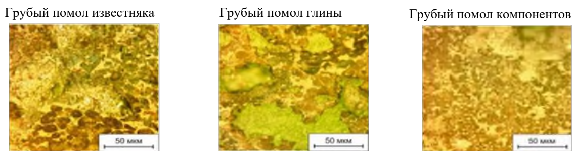
Рисунок 5 – Влияние степени измельчения исходных компонентов на микротопологию клинкера
