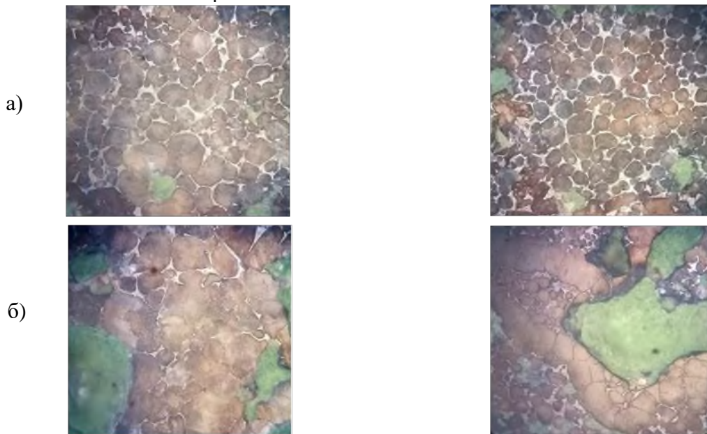
Рисунок 6 – Микроструктура белита: а) – белит характеризуется неравномерной структурой, представленной зёрнами округлой некруглой формы, при этом отдельные кристаллы имеют зубчатые границы; б) – скопления зёрен белита
