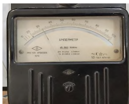
Рисунок 7 – Показания амперметра при коротком замыкании 1 витка
