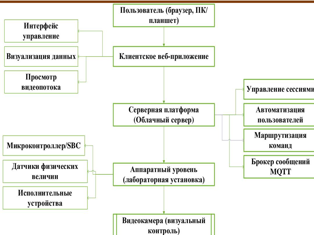
Рисунок 1 – Архитектура облачной платформы удалённого физического эксперимента
