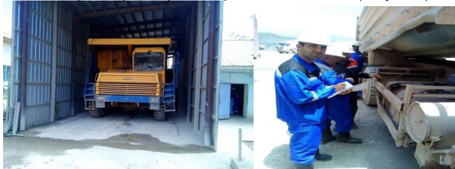
Рисунок 1 – Момент взвешивания автомобиля БелАЗ–7540В и измерения расхода топлива на строительном объекте.
