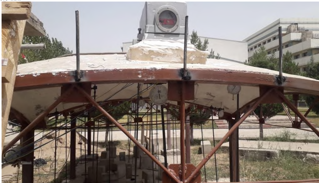
Рисунок 4 – Подготовка и установка приборов для определения статических нагрузок
