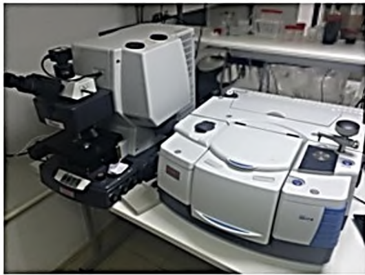
Рисунок 4 – ИК-Фурье спектрометр NICOLET iS50 внешний вид (а) и оптическая схема (б):
