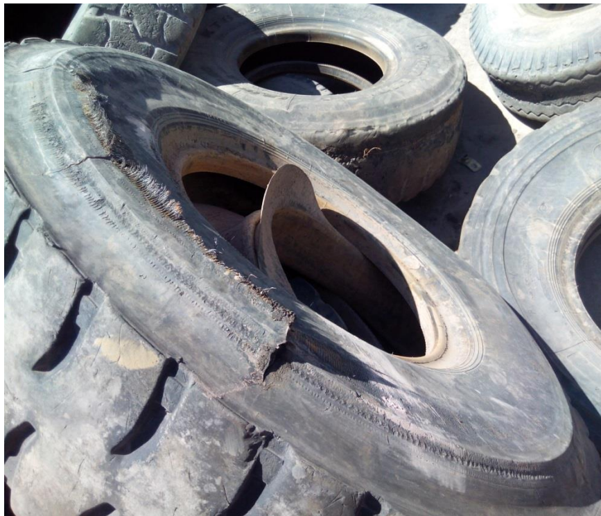
Рис.1 Боковой срез на автошине модели Karsen 12.00 R 20
