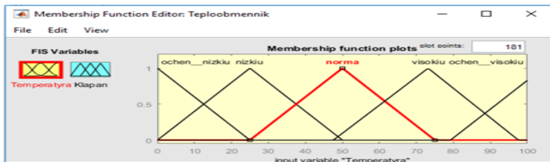
Рис.2. Функция принадлежности для переменной, определяющей состояние регулирующего клапана.
