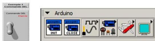
Рис 3а, 3б. Изображение логического переключателя «СТОП», вид палитры Arduino в LabView.
